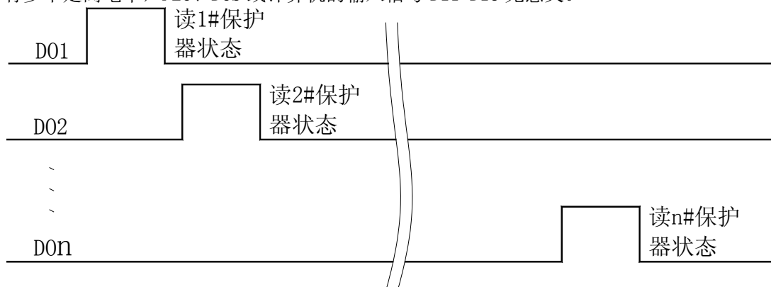
PLC 读取多台 AMDPH-X/F601 系列电动机保护器时序图
